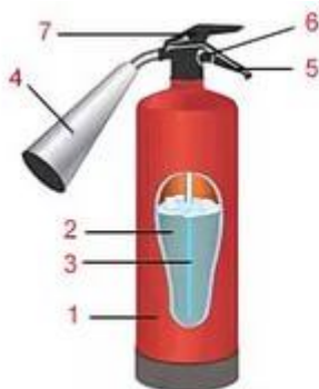
Рис. 4. Конструкция переносного углекислотного огнетушителя
