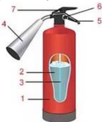
Рис. 4. Конструкция переносного углекислотного огнетушителя
